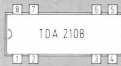
Fig. 2. Het IC TDA2108 zit in een 14 pins behuizing waarvan 6 pennen zijn weggelaten.
